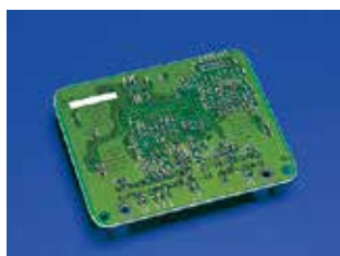
■両面／貫通多層プリント配線板 層間の接続に貫通穴を使用した両面あるいは多層プリント配線板。耐熱性や電気特性に優れている
