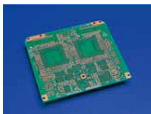
■PPBU レーザーでピアを形成するスタンダードなビルドアップ配線板。優れた剛性力と信頼性を備えている
