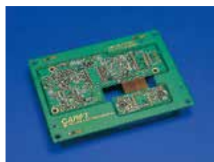
■CARFT コネクタ機能の内蔵でモバイル機器の小型化・薄型化に対応した高機能リジッドフレキシブル基板
