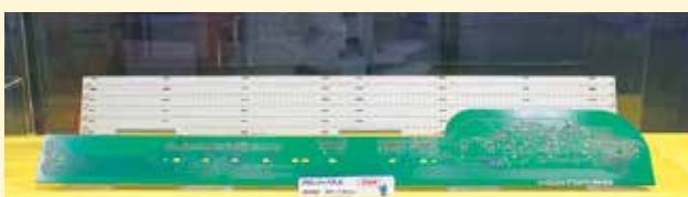
車載フロントパネル（照明分野向けに1200mm長尺基板を提案）
