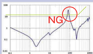
インプットインピーダンス (電圧変動対策)
